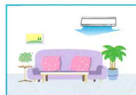
ในกรณีที่ Intelligent Eye ไม่สามารถตรวจจับการเคลื่อนไหวของคนได้เป็นเวลา 20 นาที ระบบจะปรับอุณหภูมิเพิ่มขึ้นอัตโนมัติ 2 องศาเซลเซียส เพื่อประหยัดพลังงาน
